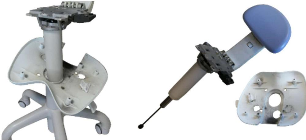
Retirez le cache-tube du logement du vérin à gaz dans le piètement à roulettes.
